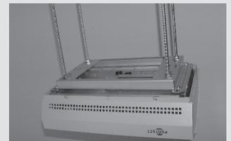
Die Nebelkanone kann entweder mit oder ohne Gehäuse, also sichtbar oder unsichtbar, angebracht werden. Aus Belüftungsgründen sollte die Kanone mindestens 2 cm unterhalb des Hängebodens angebracht werden.
