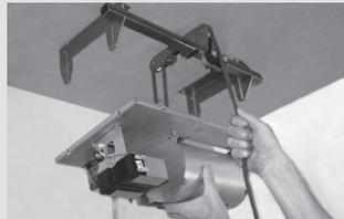
Das Hebewerkzeug stellt eine große Hilfe bei der Deckeninstallation dar. Sehen Sie sich das Video auf [www.protectglobal.com](http://www.protectglobal.com) an.
