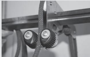
Die selbstschließenden Umlenrollen ermöglichen die Installation durch nur eine Person.
