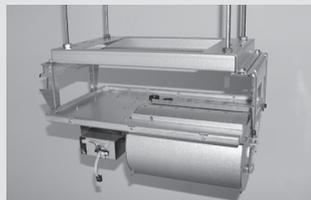
Das Hebewerkzeug wurde entfernt, sodass jetzt genügend Platz zum Anschließen von Strom- und Signalkabeln vorhanden ist.
