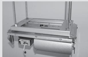
Zuletzt muss die Nebelkanone gerade nach oben gegen die Metallplatte gedrückt und die Schrauben vollständig angezogen werden.
