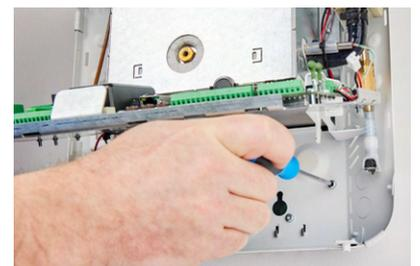
Verwenden Sie zwei Schrauben, um die Fog Cannon™ von innen an der oberen linken und unteren rechten Ecke fest zu befestigen.
