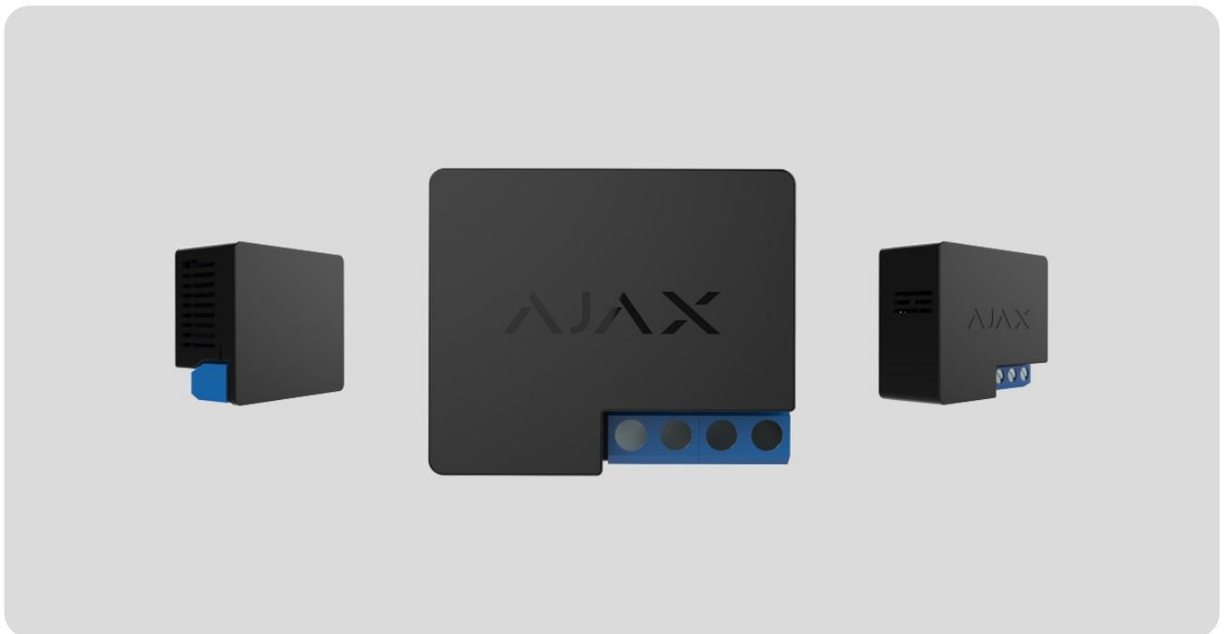
**WallSwitch** ist ein Leistungsrelais zur Fernsteuerung einer 110/230 V~ Stromversorgung. Die Relais-Stromversorgung ist von den Versorgungsklemmen nicht elektrisch isoliert; daher schaltet WallSwitch nur die an den Versorgungsklemmen ankommende Spannung um. Das Gerät verfügt über einen Energieverbrauchszähler und ist mit drei Schutzfunktionen gegen Spannung, Strom und Temperatur ausgestattet.
